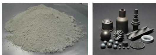
独自製法で生み出された極めて高純度の窒化珪素は、高精度・高耐久のセラミックス製品を実現。ベアリングボールなどとして車の電動化を支える。
