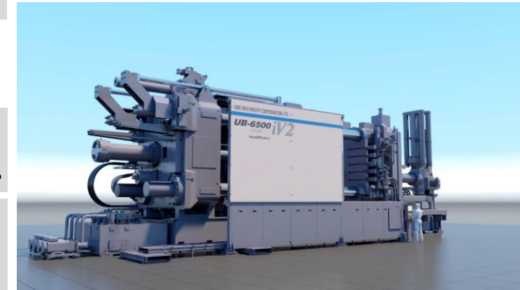
UBEマシナリーで開発した、 ギガキャスト用超大型ダイカストマシン。 型締力は6,500t。
